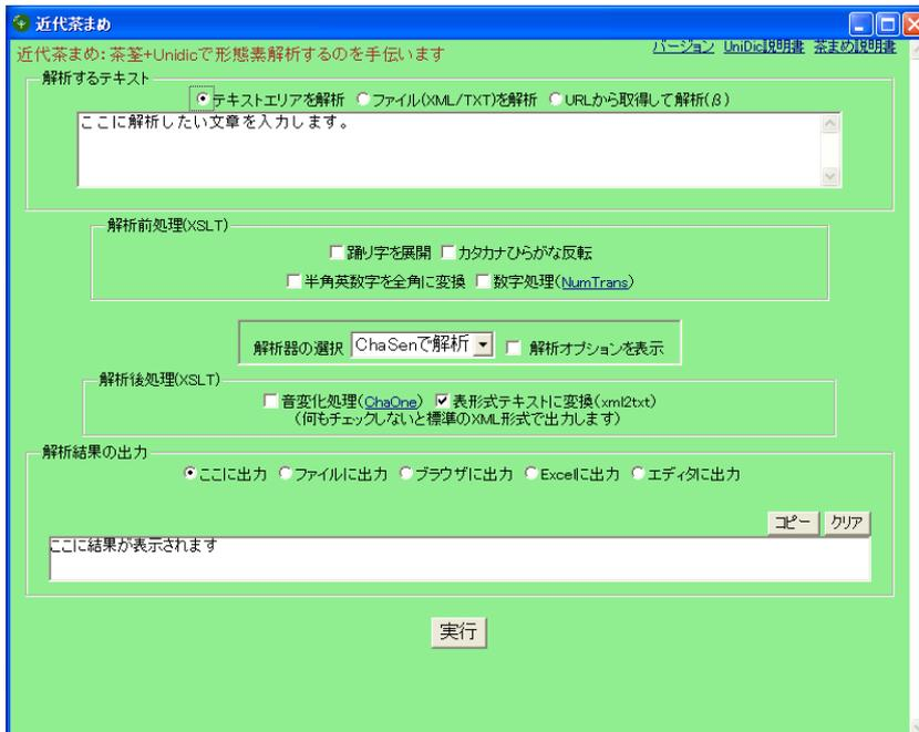
この画面の上から下へと順に処理方法を指定してゆき、最後に「実行」ボタンを押すことで形態素解析が完了し、結果が出力されます。
